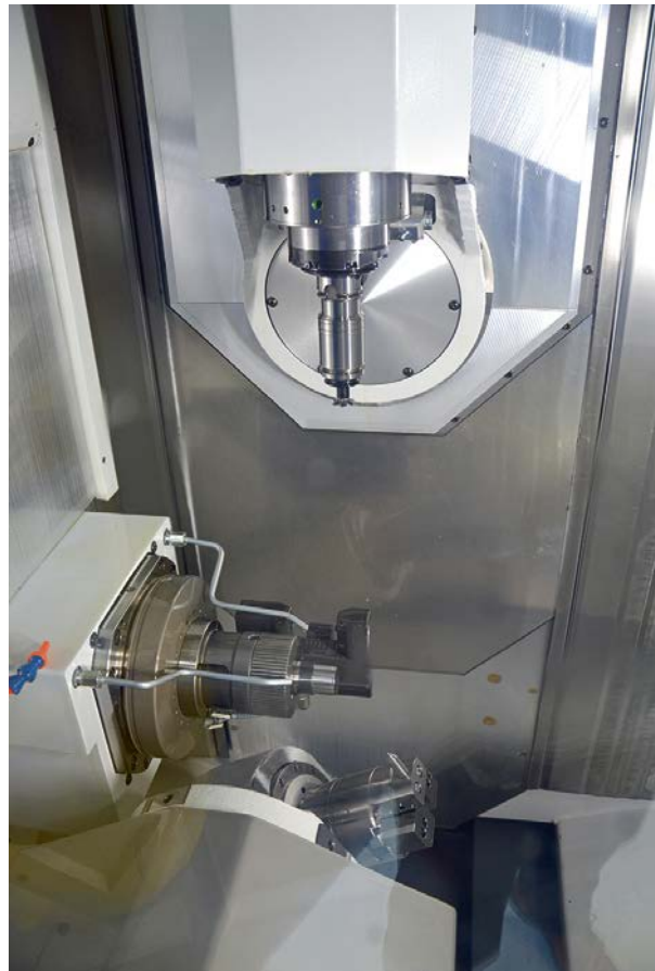
4 Arbeitsraum des 5-Achs-Fräsdrehzentrums Chiron FZ08 MT Precision+: Die Maschine ist vom Grundaufbau her für Hochpräzisionsanwendungen gerade auch im Feinmechanik-Umfeld konzipiert (© Hanser)
